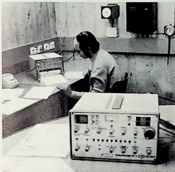
Bild 8. Meßraum im Empfangsturm; im Vordergrund der Empfänger auf dem Drehtisch, hinten links der Schreiber zum automatischen Aufzeichnen der Richtdiagramme
